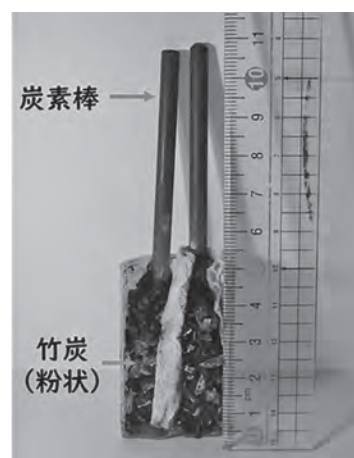
図2 竹炭を用いた燃料電池
