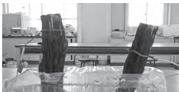
図1 備長炭電池(備長炭を電極として用いている)
